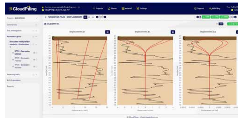
Screenshot uit de software voor de toepassing van een windturbine. Visualisatie van het horizontale en verticale gedrag waardoor materiaaloptimalisaties van gemiddeld 30 % ontstaan.
